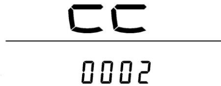
2 代表 2 粒磁钢 (车轮每转 1 圈输出 2 个信号)
